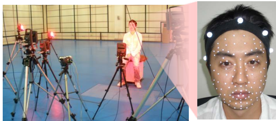
Vicon 社のモーションキャプチャ装置 (高価な赤外線カメラ12台が用いられる。顔には約100個の赤外線マーカーが貼り付けられる。内部ノイズの除去処理に数日かかる。)
