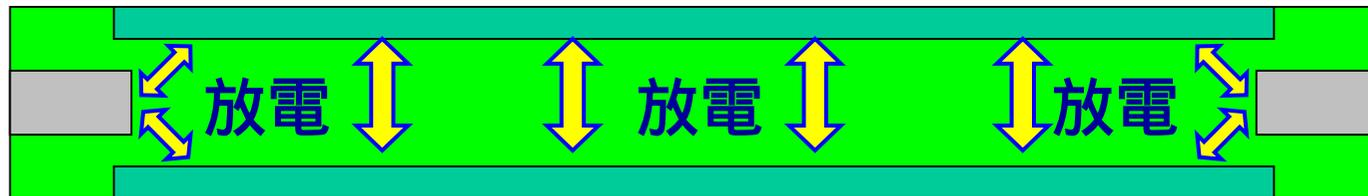
内部電極・外部電極間の**放電による損傷**(黒化)が発生。
